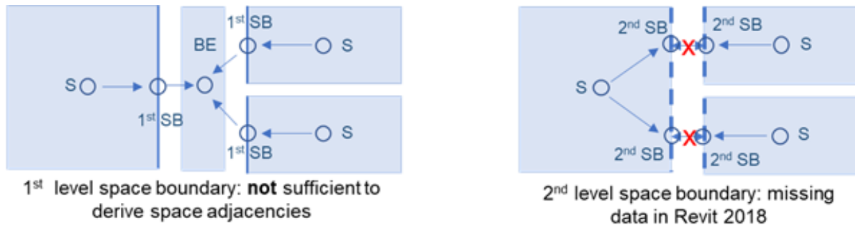
Abbildung 5 Einschränkungen des Revit- und IFC-Datenmodells in Bezug auf räumliche Adjazenzbeziehungen
