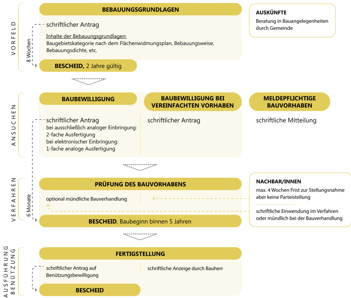
Abbildung 23: Steiermark – Schematischer Verfahrensablauf von Baugenehmigungsverfahren
