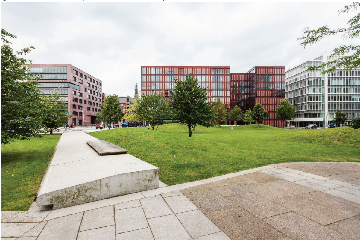
Abbildung 85 Hafencity – unterschiedliche Abstufungen von Versickerungsfähigkeit Quelle: Martin Grabner, Institut für Städtebau, TU Graz
