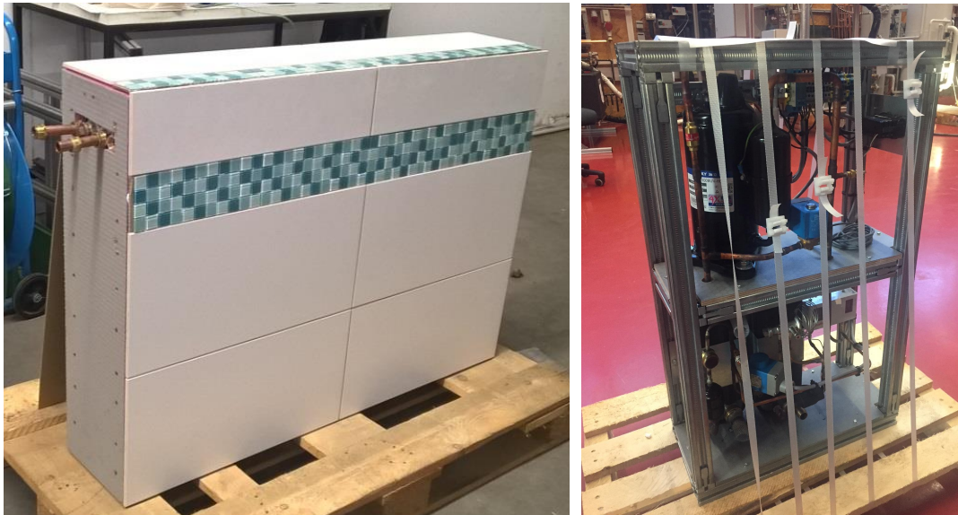
Abbildung 8: Funktionsmuster Speichereinheit bestehend aus drei Modulen (links) und Trinkwarmwasserwärmepumpe (rechts) für Gebäudeintegration oder Vorwandinstallation Messergebnisse und Modellvalidierung zur Heizungswärmepumpe
