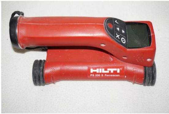
(a) Bewehrungssuchgerät HILTI Ferroskan PS 100 S
