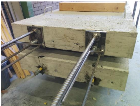
(c) Montage der thermischen Entkopplungselemente
