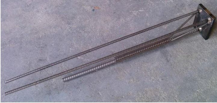
Abbildung 33: Thermische Entkopplung System SII aus einer Baustahl-Edelstahlkombination
