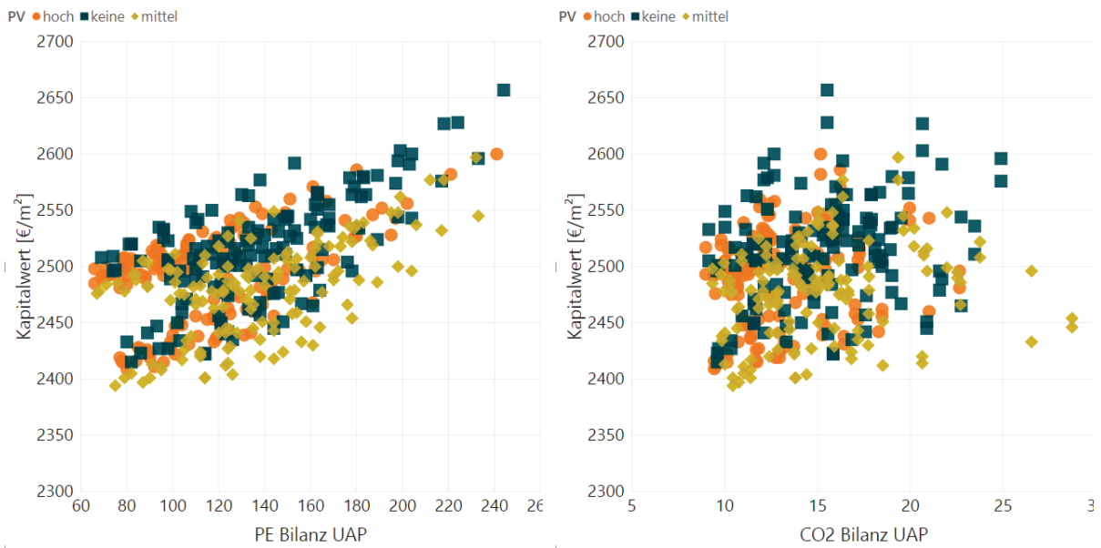
Abbildung 63: Untersuchung des Einflusses der Photovoltaikanlage auf den Kapitalwert, die Primärenergiebilanz (links) und die CO 2 Bilanz (rechts) beim Mehrfamilienhaus +ERS
