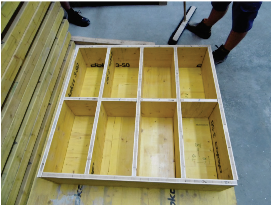
Abbildung 63 Schalung für die Versuchskörper, Foto Institut für Konstruktiven Ingenieurbau, TU Graz
