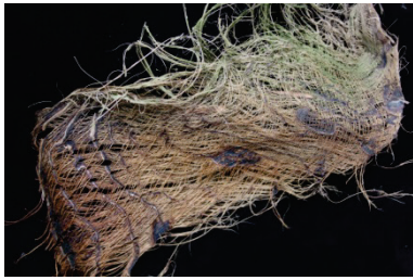
Abbildung 75: Palmfaserstruktur der Palme Howea Forsteriana
