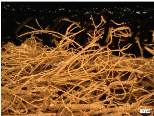
Abbildung 78: Mikroskopische Aufnahme Palmfaserstruktur „ Livistona chinensis “ mit „Pressotex 75161“ (Aufnahme: Mag.rer.nat. Dr.rer.nat. Florian Mittermayr, Institut für Materialprüfung und Baustofftechnologie, 08.06.2018)
