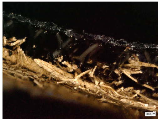
Abbildung 79: Mikroskopische Aufnahme Palmfaserstruktur „ Cocos nucifera “ mit „Pressotex 75161“ (Aufnahme: Mag.rer.nat. Dr.rer.nat. Florian Mittermayr, Institut für Materialprüfung und Baustofftechnologie, 08.06.2018)
