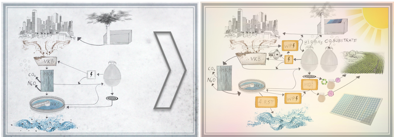
Abbildung 1: Herkömmliche Kläranlage reinigt das Abwasser mit Vor-, Haupt- und Nachklärung (linke Darstellung). In einem Systemverbund wird der Prozess je nach Auslegung mit einer Biogasanlage, einer Wärmepumpe, eigener Stromproduktion und Düngemittel-Herstellung ergänzt. So werden Wertstoffe besser genutzt und die Wirtschaftlichkeit optimiert (rechte Darstellung).
