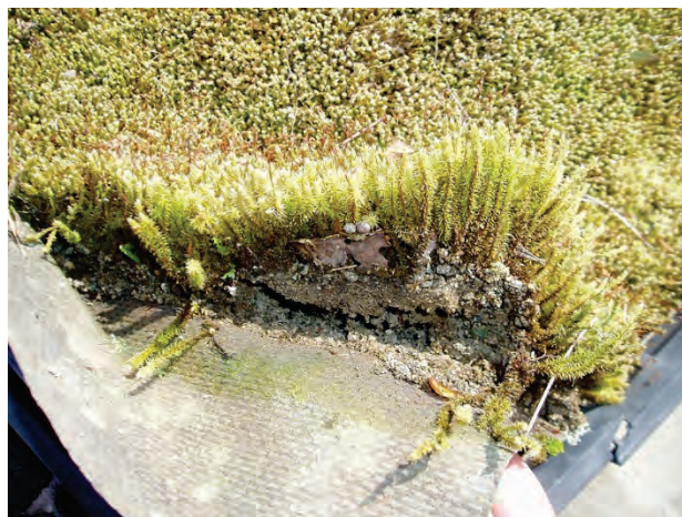
Abbildung 79: Moos mit Unterlagsvlies auf Sandlage; Bildquelle: http://item.rakuten.co.jp/ryokken/sg-1/#sg-1
