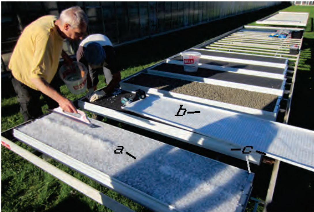
Abbildung 161: Bestandteile der Paneele: a...Granulat, b...Fließ, c...Metall-Grundgerüst (Bildquelle: Eigene Photographie E. Heiduk, bearbeitet von J. Gätz)
