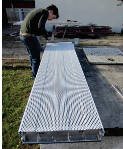
Abbildung 166 : Beschichtete Aluminium-Lärmschutzplatte (Bildquelle: eigene Photographie – E. Heiduk)
