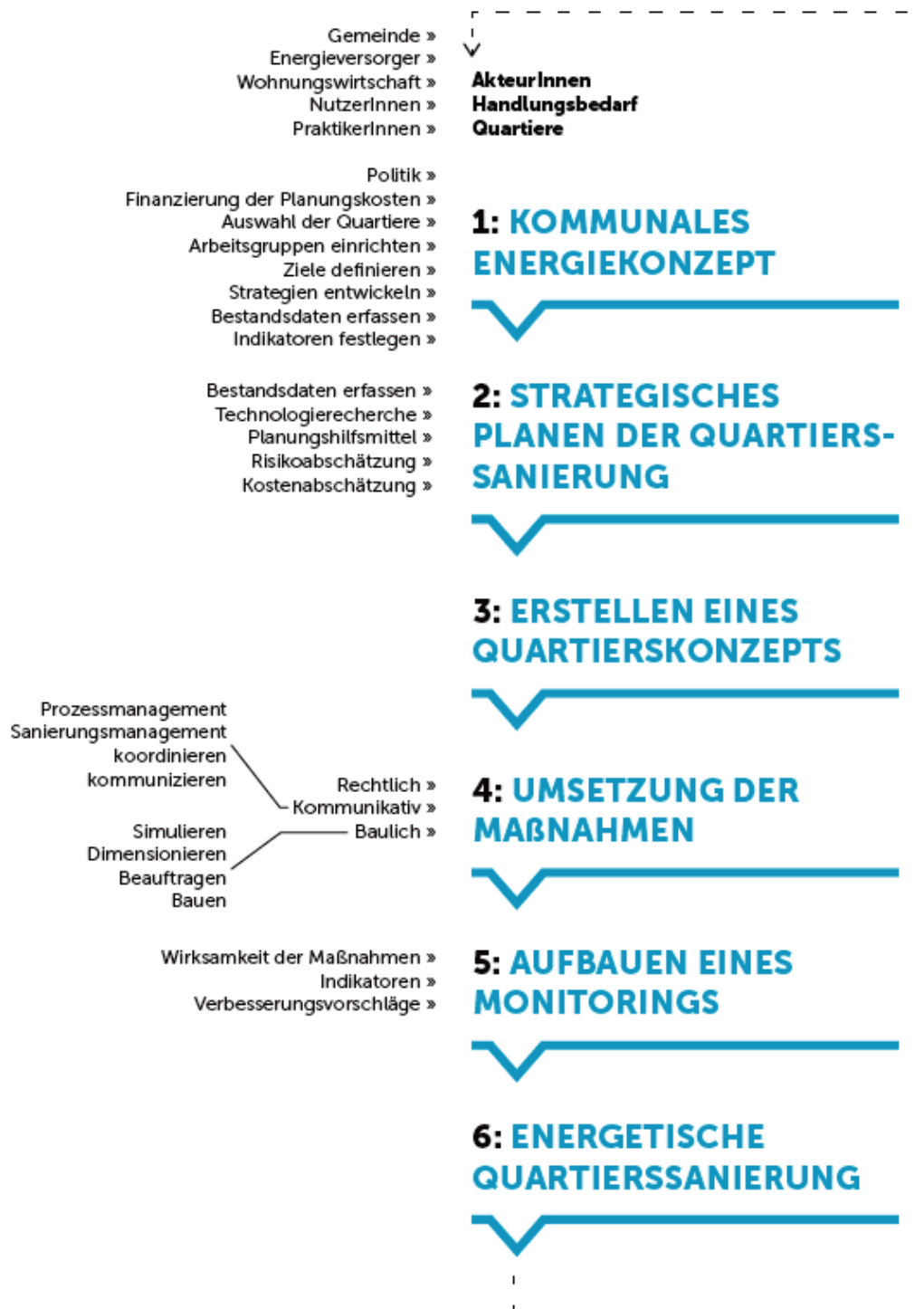
Abbildung 64: Idealtypischer Ablauf einer energetischen Quartierssanierung
