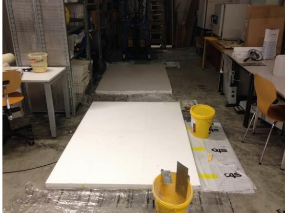
Abb. 50: Links: Aufkleben von Dämmstoff auf Tragplatten Rechts: Komplette Lage mit 4 cm Dämmstoff (eigene Darstellung)
