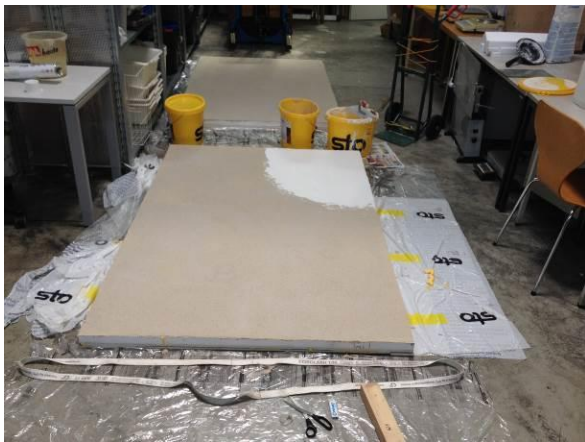
Abb. 51: Links: Beschichtung mit Armierungsschicht Rechts: Beschichtung mit Deckputzschicht (eigene Darstellung)
