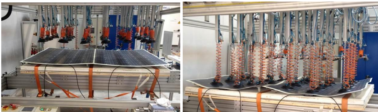
Abb. 58: Links: DAS-Energy-Modul mit Verformung durch Eigengewicht Rechts: und maximaler Druckbelastung (eigene Darstellung)
