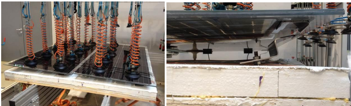
Abb. 57 Links: Das SolarWatt-Modul beim Drucktest Rechts: Knapp vor dem Auseinanderrutschen beim Sogtest (eigene Darstellung)
