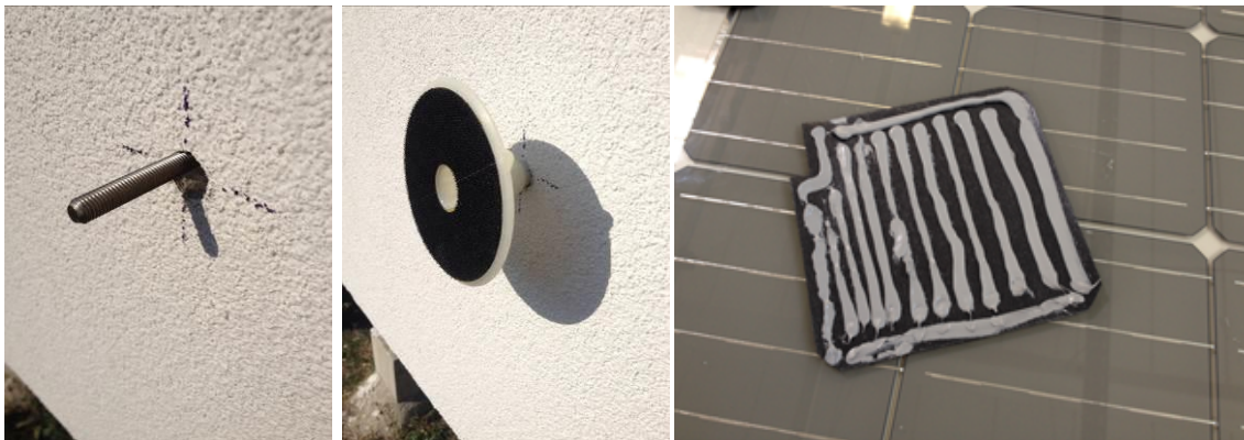
Abb. 37: Klett dübel und Gewindeschraube montiert, Flaschgewebe mit Kleber und aufgeklebt (eigene Darstellung)
