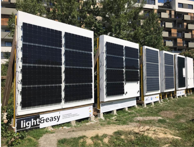
Abb. 34: Montage der PV-Paneele auf den Mock-Up-Testflächen (eigene Darstellung)
