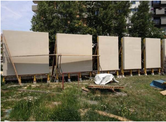
Abb. 32: Links: Armierungsbeschichtung Rechts: Beschichtung mit weißem, mitteldickem Putz (eigene Darstellung)
