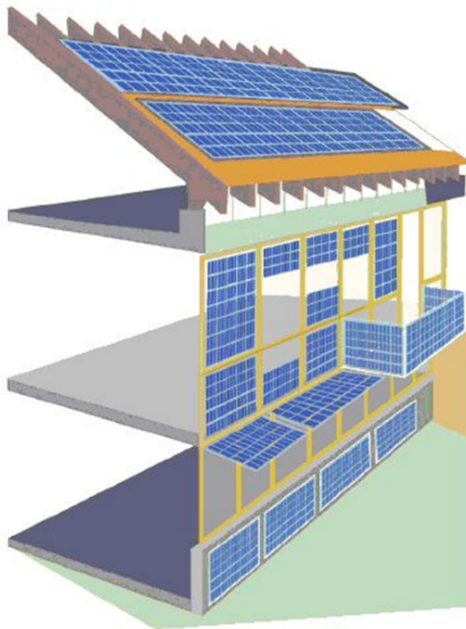
Abb. 2: Möglichkeiten der PV-Gebäudeintegration. [2]
