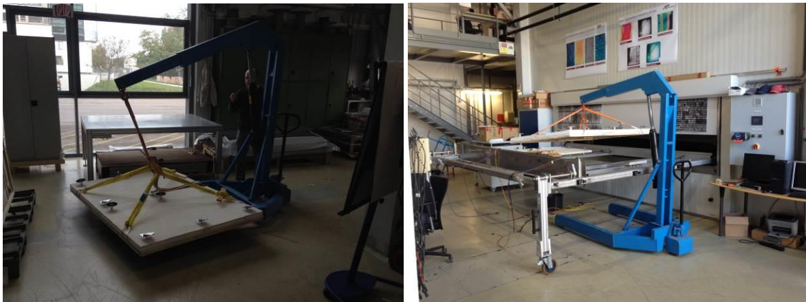
Abb. 54: Links: Transport der Testflächen Rechts: Einheben der Testflächen in den Prüfstand (eigene Darstellung)
