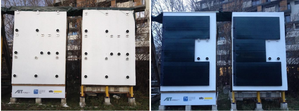
Abb. 44: Die montierten Befestigungselemente und die Montage der MiaSole-Module. (eigene Darstellung)
