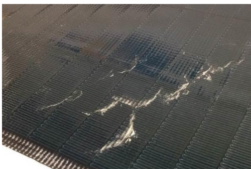
Abb. 46: Mit Fingern zusammengeschobener, anhaftender Staub auf MiaSole. (eigene Darstellung)
