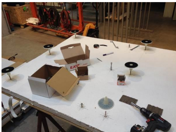
Abb. 52: Links: Markieren der Schraubenpositionen Rechts: Versetzen der Tragschrauben (eigene Darstellung)
