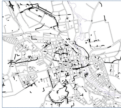
Abbildung 11: Karte stillgelegter Nieder- und Mittelspannungsstromkabel (dicke schwarze Linien) in der Innenstadt von Linköping (Krook et al. 2011).
