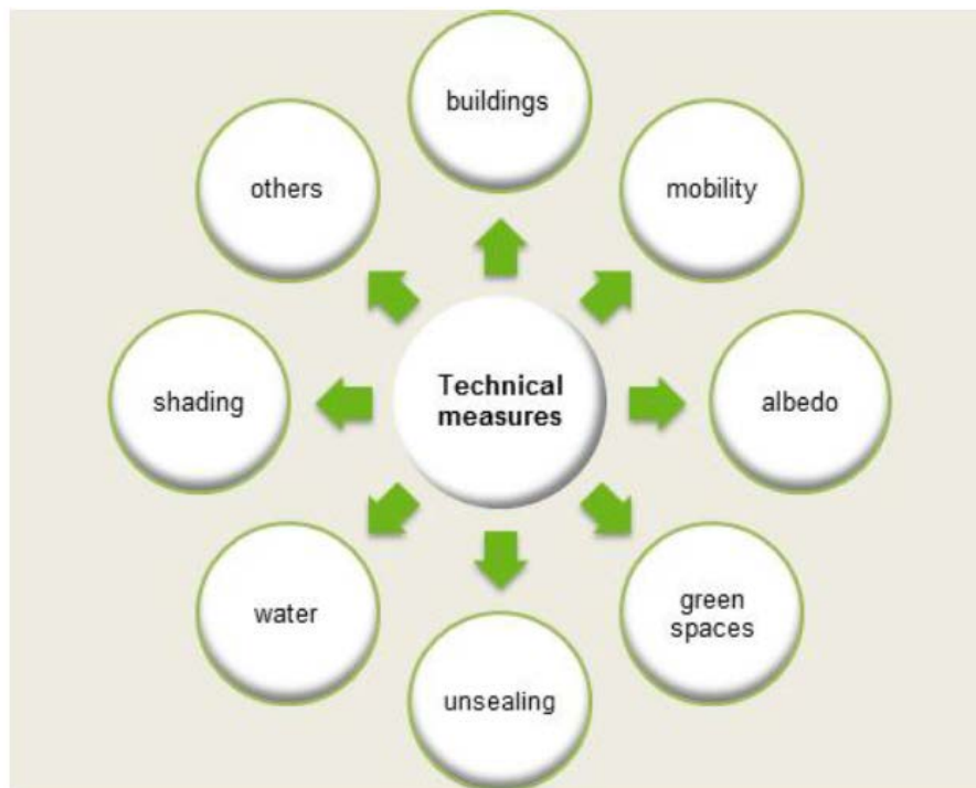
Abbildung 2: Technische Maßnahmen zur Vermeidung und Anpassung an den UHI-Effekt in Wien (Quelle: Czachs et al., 2013).
