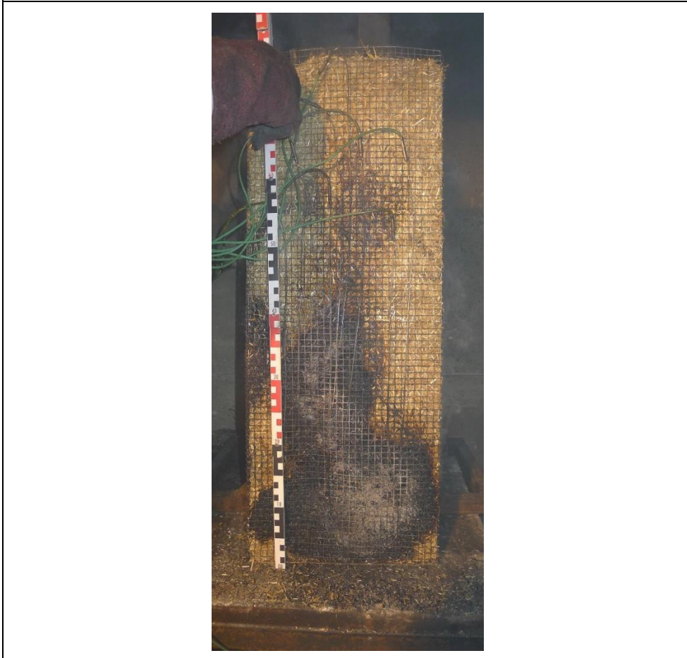
Stroh mit APP, Rückseite nach 30 Minuten
