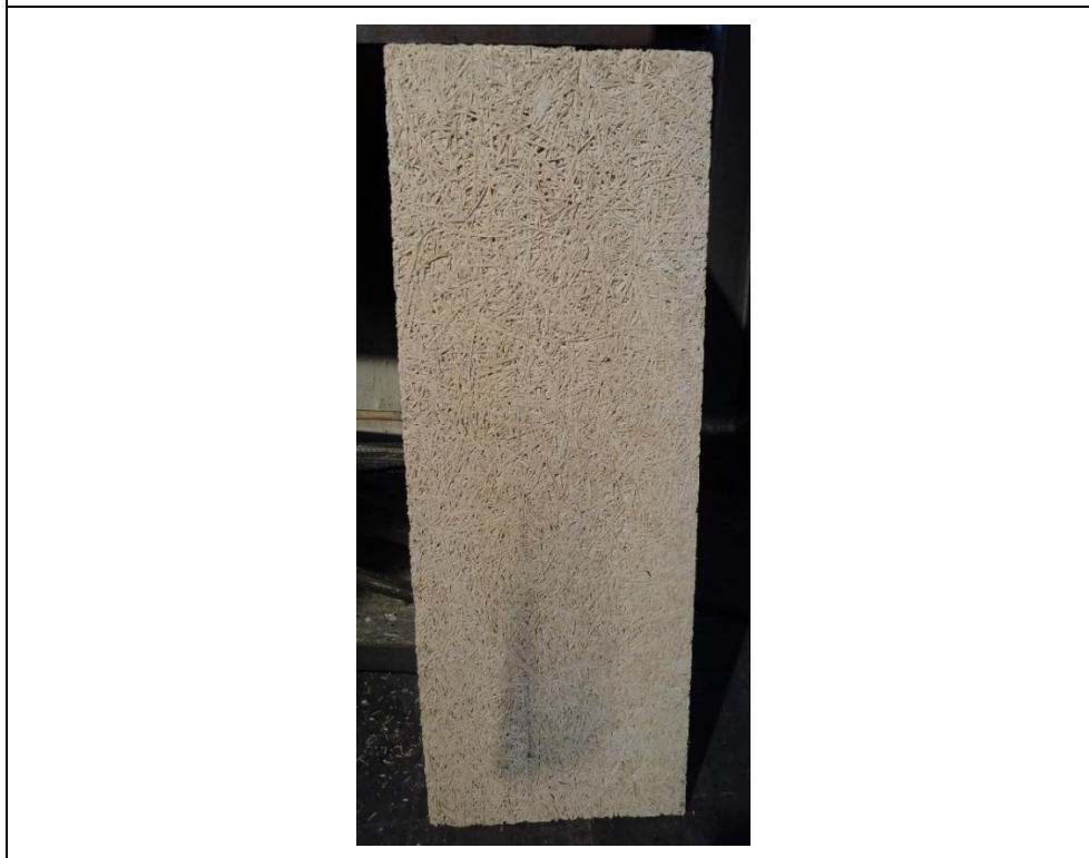
Beflammte HWL Platte, geringfügig geschwärzt
