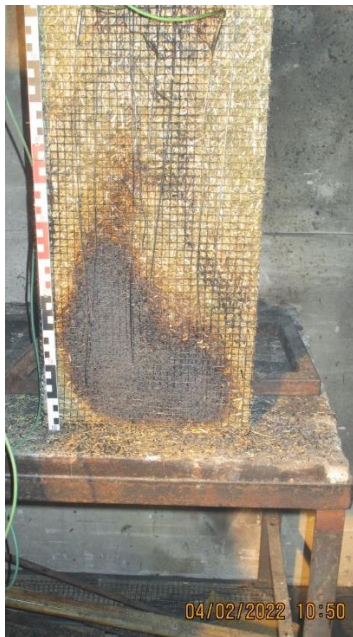
Stroh mit BG1455, Rückseite nach 30 Minuten
