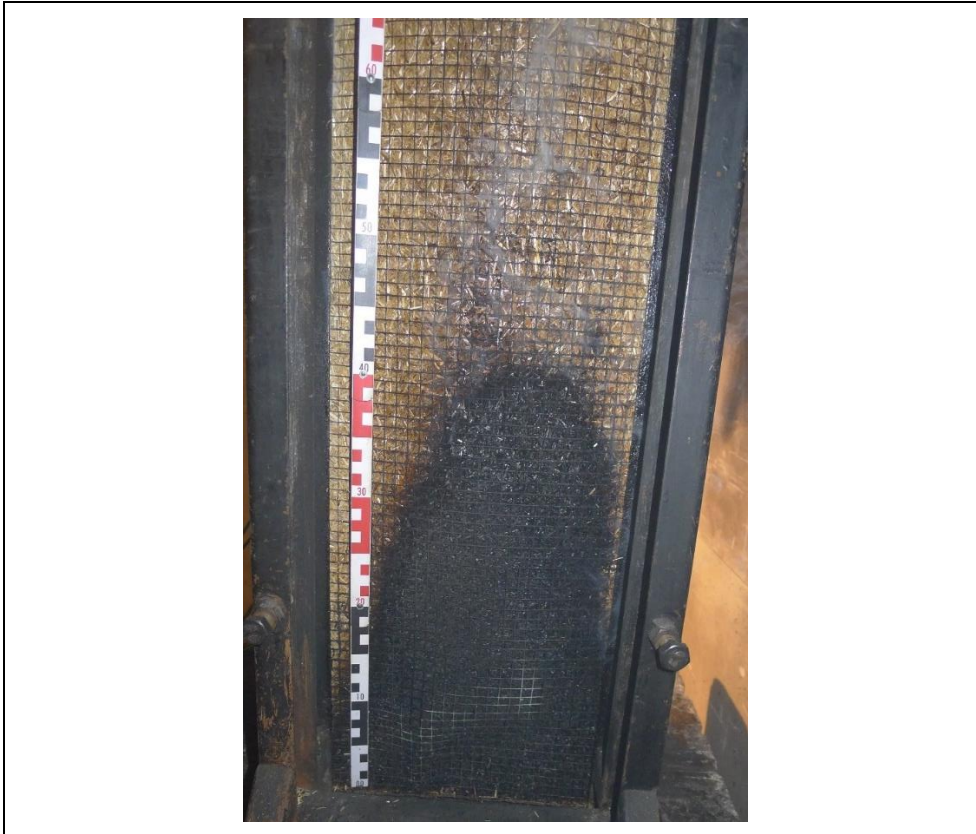
Stroh mit AMU (2. Versuch), beflamnte Seite nach 30 Minuten
