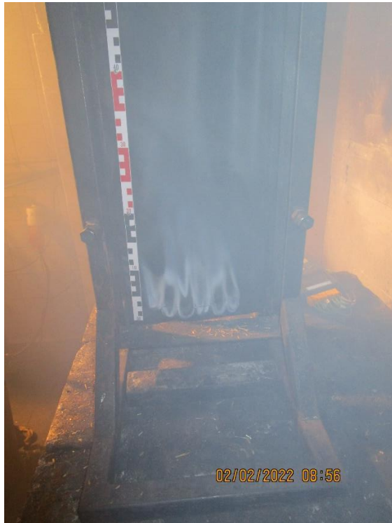
Stroh mit Folie nach 15 Minuten Beflammung, starke Qualmbildung
