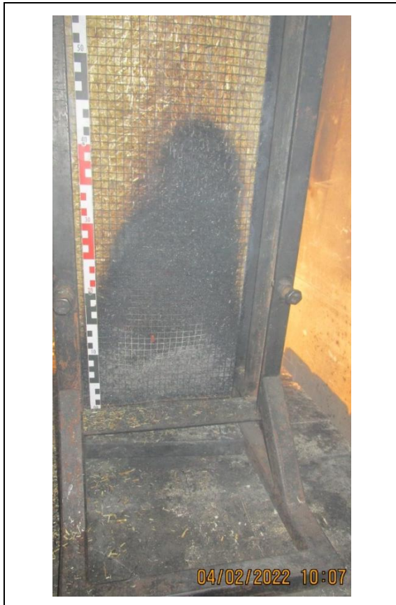
Stroh mit Tannin, beflammte Seite nach 30 Minuten
