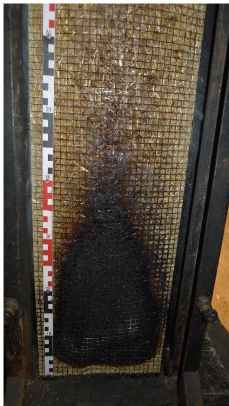
Stroh mit AMU (2. Versuch), beflammete Seite nach 15 Minuten
