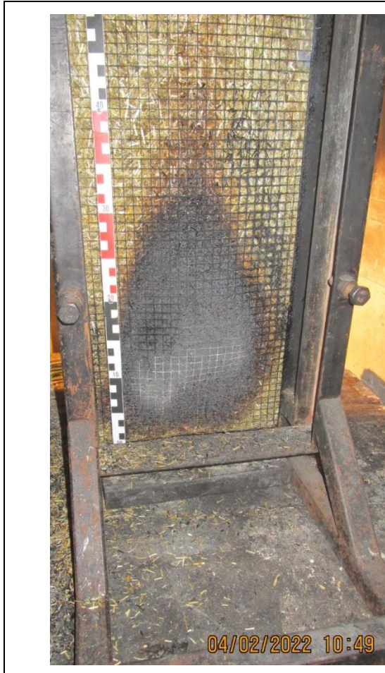
Stroh mit BG1455, beflammte Seite nach 30 Minuten
