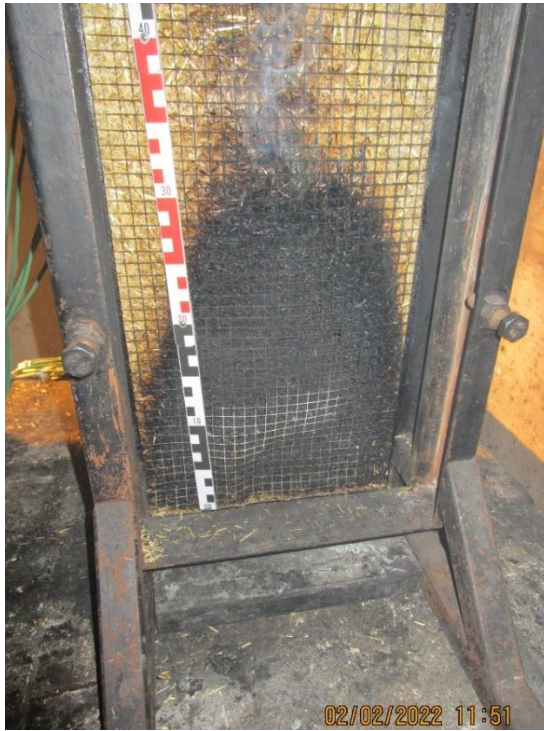
Stroh mit AMU (beflammte Seite) nach 30 Minuten
