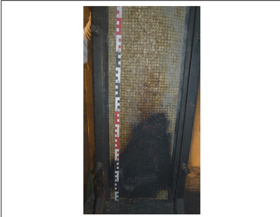
Stroh mit APP, beflamte Seite nach 30 Minuten
