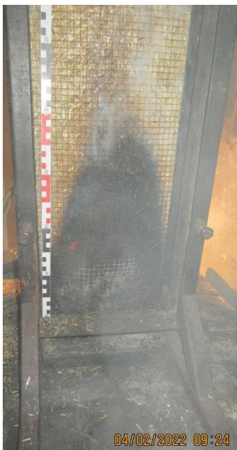
Stroh mit Burnblock nach 15 Minuten
