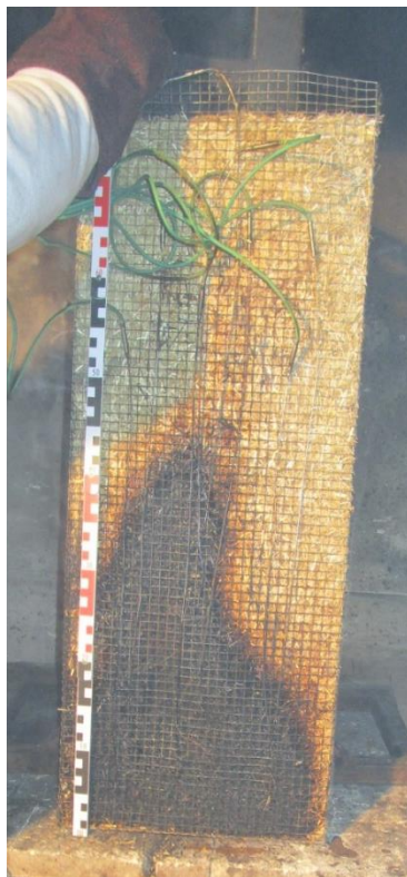
Stroh mit AMU (Rückseite) nach 30 Minuten
