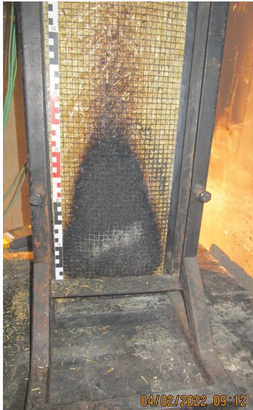
Stroh hinter der Platte 189,8 °F (87,7 °C)
