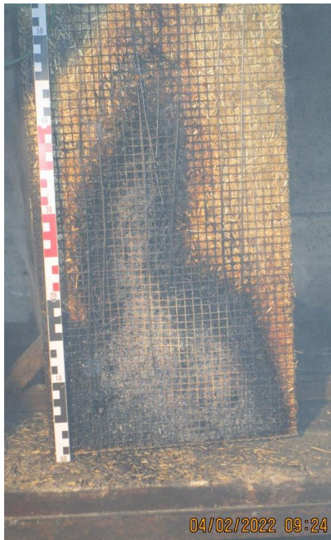
Stroh mit Burnblock nach 30 Minuten Beflammung; nach Beflammung mit Glutnest
