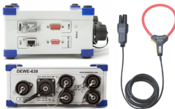
Abbildung 2-22: Eingesetzte Messinstrumente: DEWE-638-PNA (links, [A44]) und MiniFlex MA193 (rechts, [A45])
