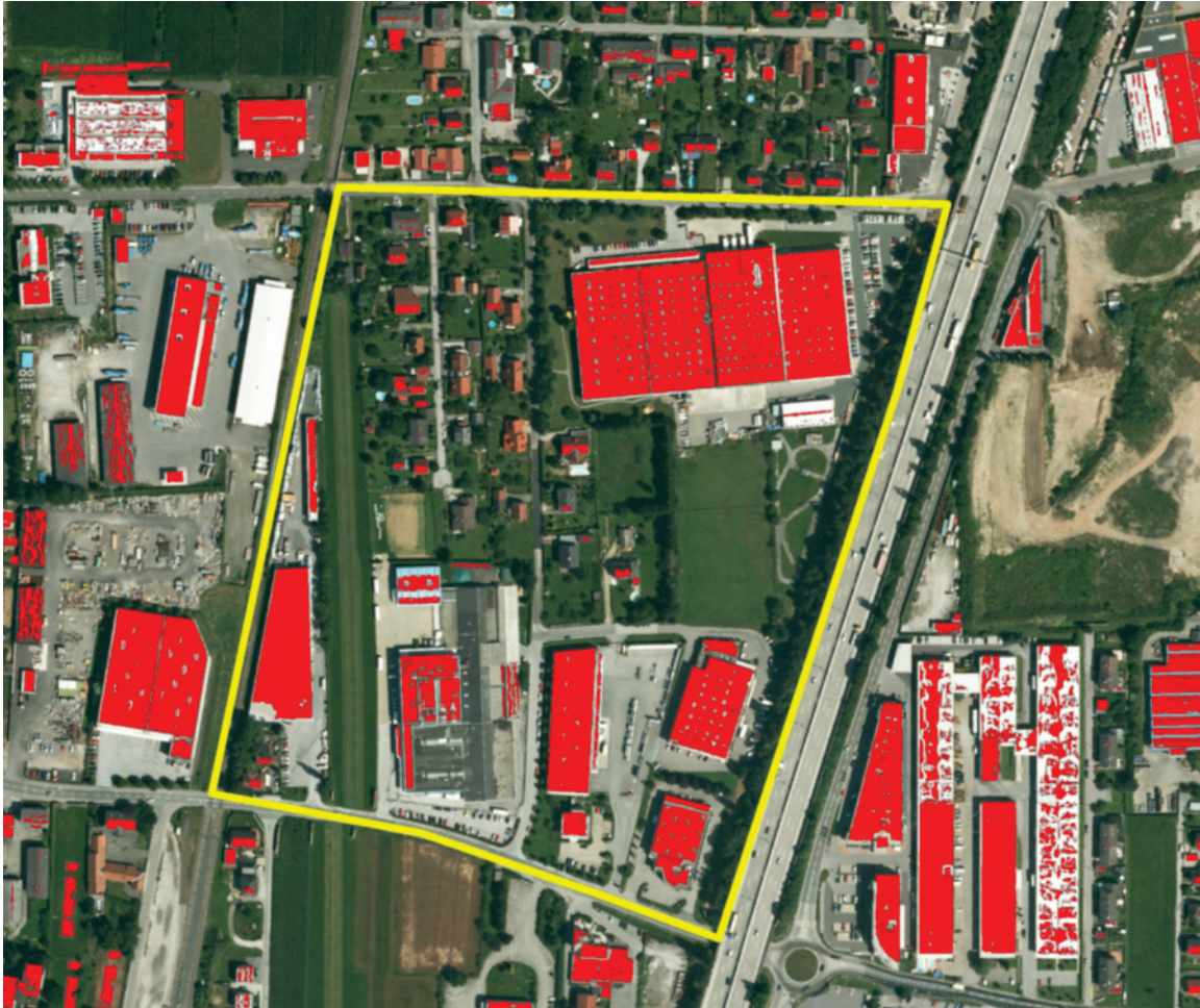
Abbildung 44: 5.310 m 2 Dachflächen von Büro- und Gewerbebauten der Kategorie „sehr gut geeignet“ laut Solardachkataster der Stadt Graz (Magistrat Graz – Stadtvermessung, 2016)
