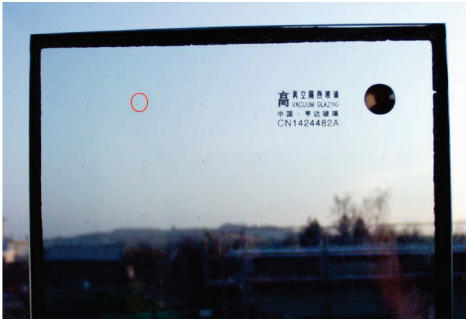
Abbildung 28: Vakuumglasscheibe von NSG, Pilkington Spacia™ (Abbildung: NSG).
