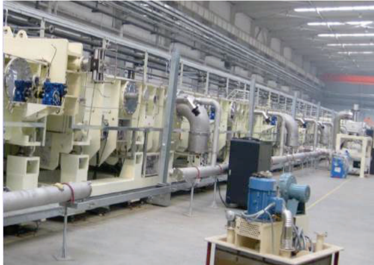
Abbildung 64: Evakuierungsöfen der Fa. Synergy (SYNERGY).
