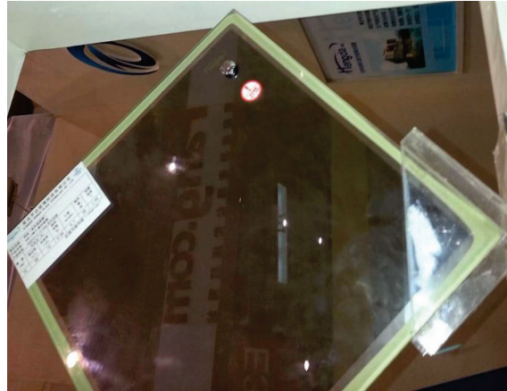
Abbildung 62: Ein Probestück Vakuumglas (VG) von Hengda [ http://www.tjskl.org.cn/images/czae8e51-pz2702078-vacuum_insulating_glass.html ].
