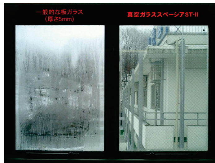
Abbildung 29: Werbesujet für Pilkington Spacia™ (Einfachscheibe mit Oberflächenkondensat, Vakuumglasscheibe ohne Kondensat. (Abbildung: http://www.sun-wind.jp/dannetsu-ketsuro ).
