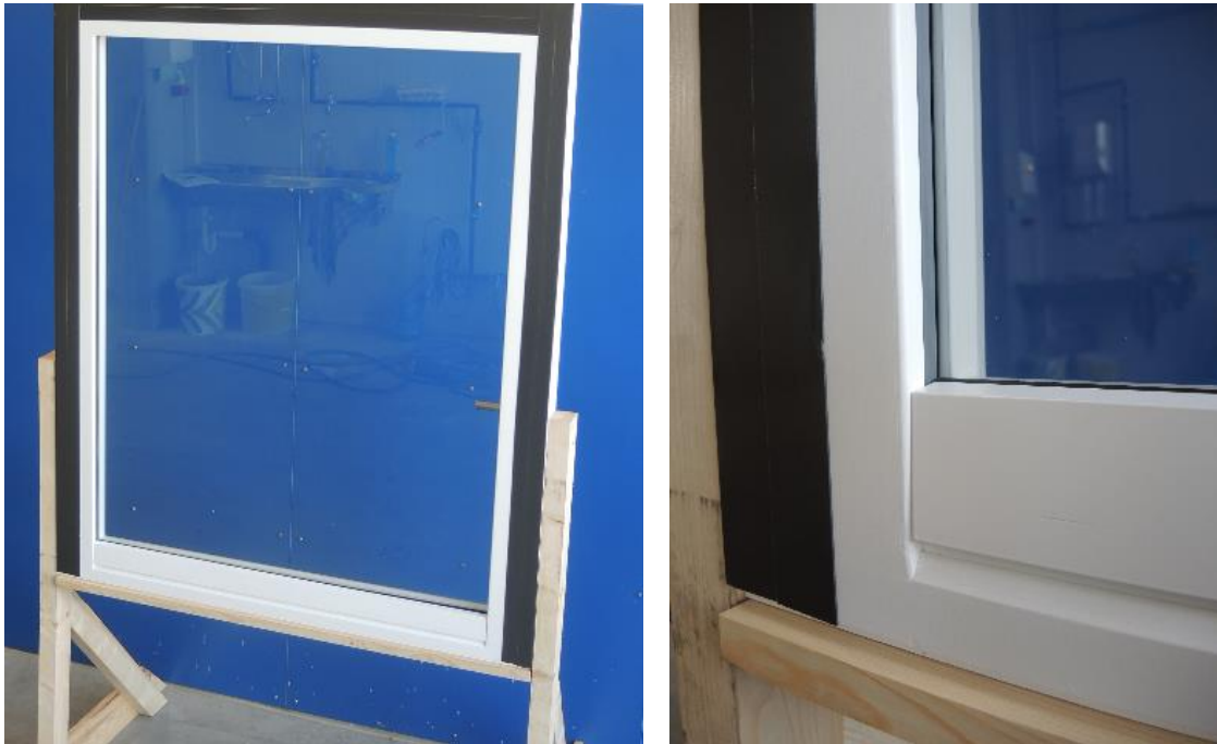
Abbildung 46: Außenansicht des innen öffnenden Fensters mit Vakuumglas außen. Schwarz abgeklebt ist jener Bereich welcher in den Leibungsanschlag der Wand reicht.
