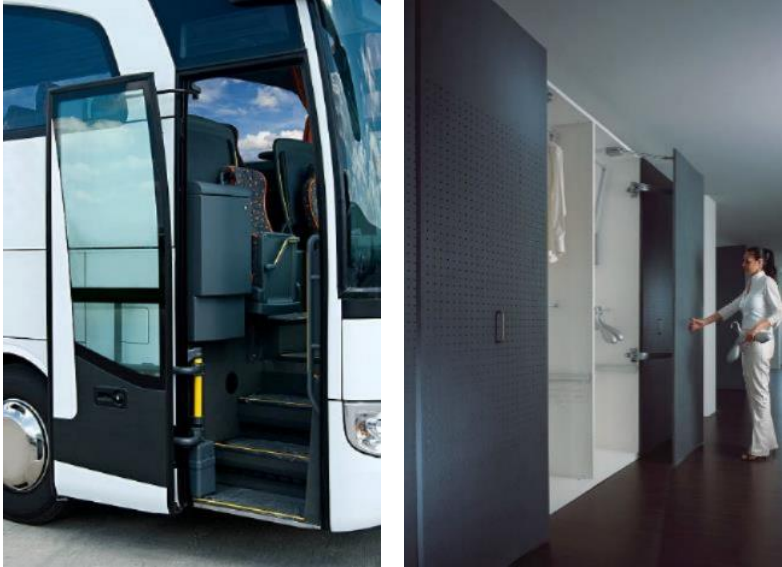
Abbildung 24: Beispiel einer Bus- und Schranktür in Dreh-Schwenkausführung
