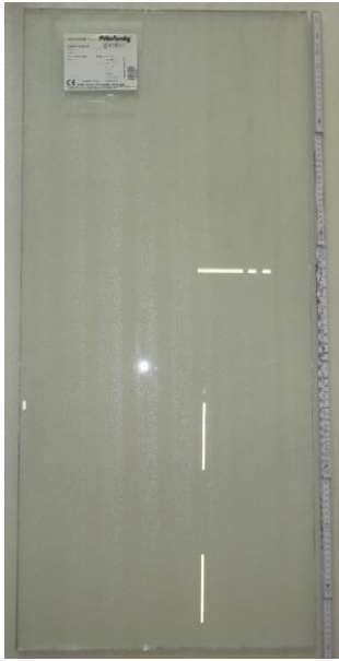
Abbildung 9: Verbundsicherheitsglas-Scheibe Typ „VSG 44.2“
