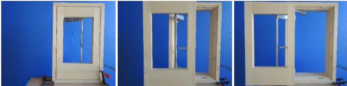
Abbildung 34: Öffnen des seitlich Dreh-Schwenkfenster von außen betrachtet
