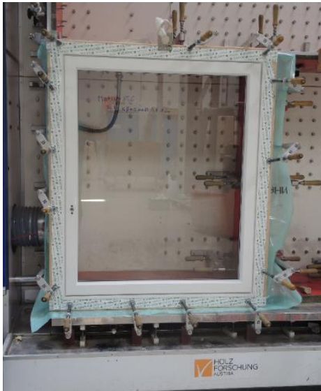
Abbildung 13: Mock-Up im Versuchsstand für Fenstertests an der Holzforschung Austria
