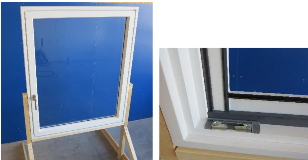
Abbildung 47: Innenansicht des Fensters, rechts ist der tiefe Falz des Stockes deutlich zu erkennen (zwischen den beiden schwarzen Dichtungen)
