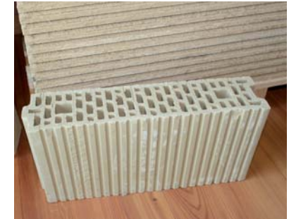
→ Roland Meingast erfindet weiter. Derzeit in der Entwicklung und Erprobung: ein statisch tragender, ungebrannter Lehmziegel. Für seine Herstellung wird praktisch keine Energie mehr verbraucht.
