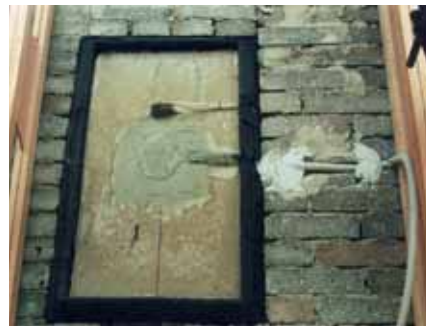
TWD-Messfeld am Demonstrationsobjekt (unverputzt)
