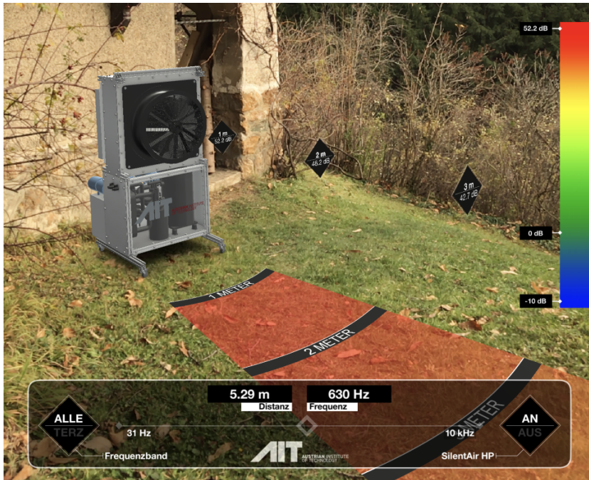
Abbildung 2 : Augmented Reality Acoustics am AIT – derzeitiger Entwicklungsstand, eine mittels AR platzierte Labor-Wärmepumpe (SilentAirHP)
