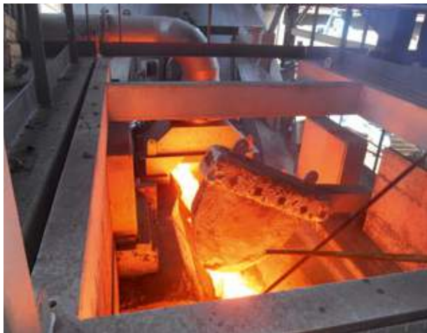
Schlackenfluss zum Granulator, Foto: Primetals Technologies
