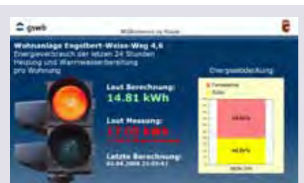
Informationsmonitore bei den Hauseingängen visualisieren den aktuellen Energieverbrauch, die aktuellen Kosten pro Wohnung und den Energiemix (Fernwärme und Solarenergie).
