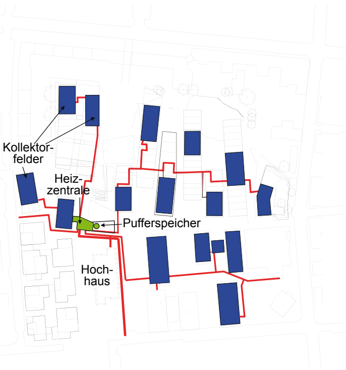
Lageplan mit Kollektorflächen, Mikronetz und Heizzentrale
