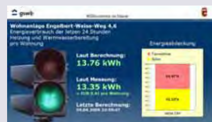
Bei zu hohem Verbrauch schaltet die „Energieampel“ auf rot, sind die Bewohner sparsam, leuchtet sie grün auf. Die Information wird auch in das Fernnetz eingespeist und steht so in allen Wohnungen zur Verfügung.
