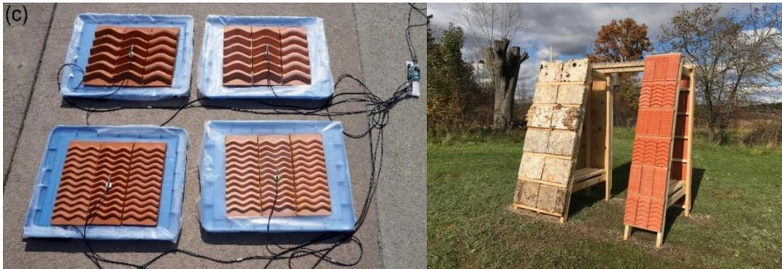
Abbildung 3: Test Setup (links) und Prototypeninstallation (rechts) mit Bioinspirierten keramischen Verdunstungselementen des Vorgängerprojektes LIWAS - Living Wall Systems, The University of Akron, USA, 2018
