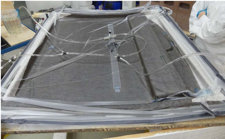
Demonstrator-Bauteil-Herstellung im Vakuum-Infusions-Verfahren
