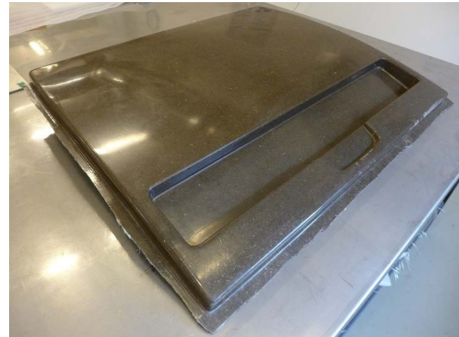
Demonstrator-Bauteil aus RSBC-Biocompositen
