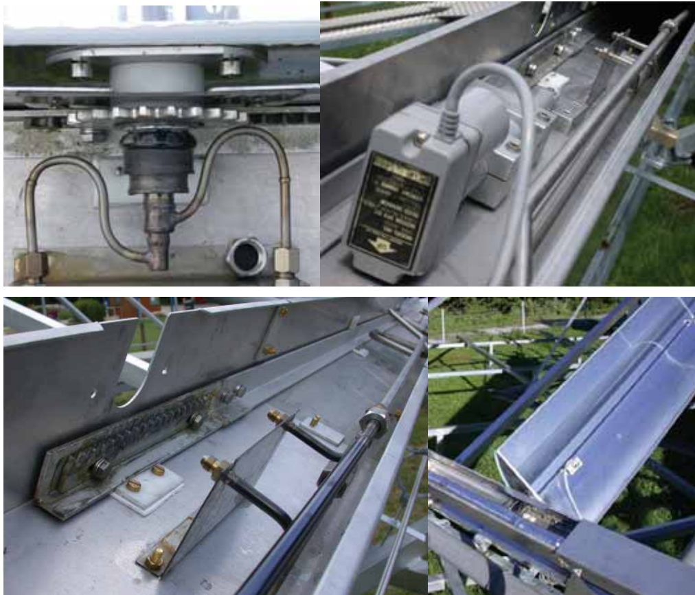
Abbildung 60: Detailansichten des Nachführmechanismus
