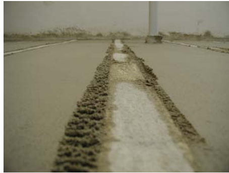
Fig. 24 Probe VI – Probleme beim Verreiben des Grundputzes
