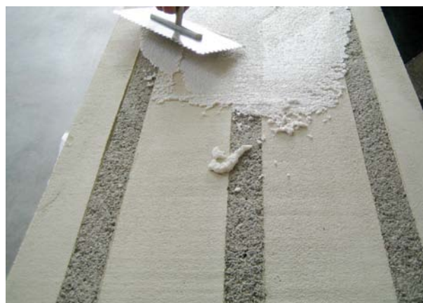
Fig. 22 Probekörperherstellung für die Hallraummessungen
