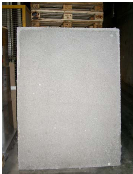
Fig. 15 Probekörperplatte 125 x 170 x 4 cm, Rückwand 22 mm OSB-Platte, seitliche Berandung aus 4 cm Fichtenlattung
