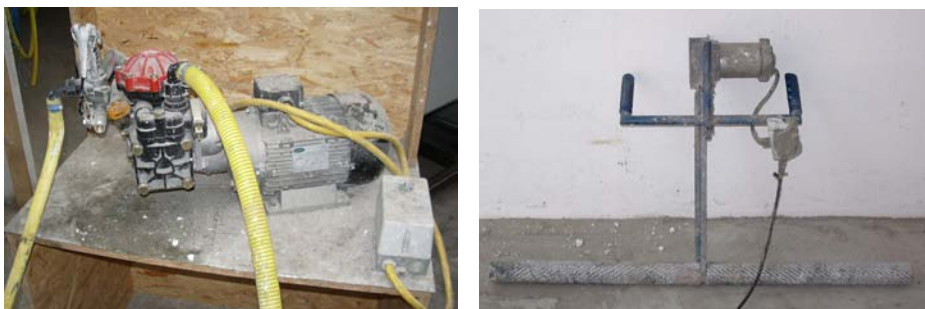
Fig. 6 Förderpumpe und Abzugsbürste
