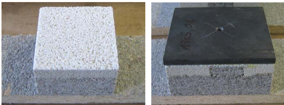
Fig. 7 Verbundsystem-Probekörper ohne und mit aufgeklebter Stahlplatte
