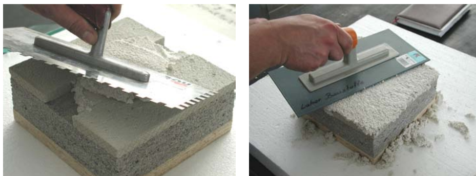
Fig. 20 Herstellung der Putzprobekörper für die Bestimmung des Absorptionsgrades
