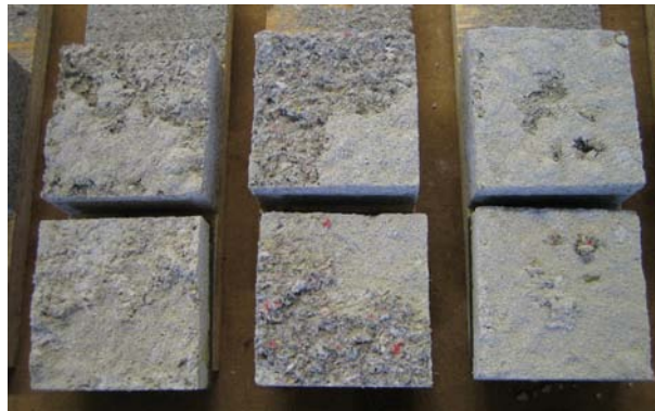
Fig. 11 Zugversuch normal zur Probenebene – Versagen in der Grenzfläche Putz / Zellulose
