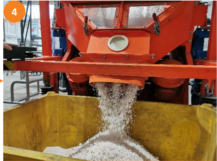
4 Sortierung des EPS von den restlichen Komponenten (Putz, Kleber etc.)
