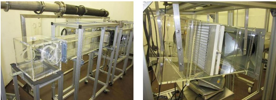
**Abbildung 2** (links): Versuchsaufbau in der AIT Klimakammer ohne Verbindungsrohrleitungen; (rechts): MPE-Röhren-Lamellen-Wärmeübertragerpaket eingebaut im Strömungskanal
