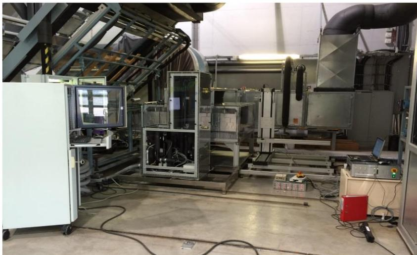
**Abbildung 11:** Messaufbau für die Vereisungsmessungen der Wärmeübertrager auf Systemebene (GreenHP).
