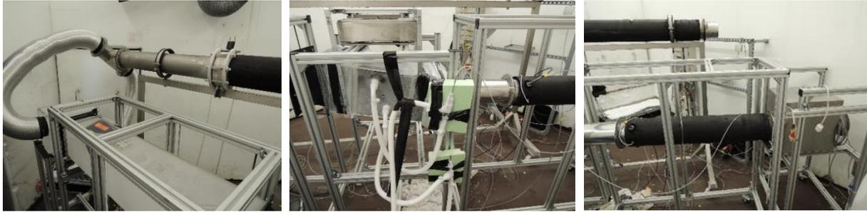
**Abbildung 4:** (links): gerades Kanalstück; (mitte): Messbox mit Waagen; (rechts): Ausgangsrohr mit Ventilator
