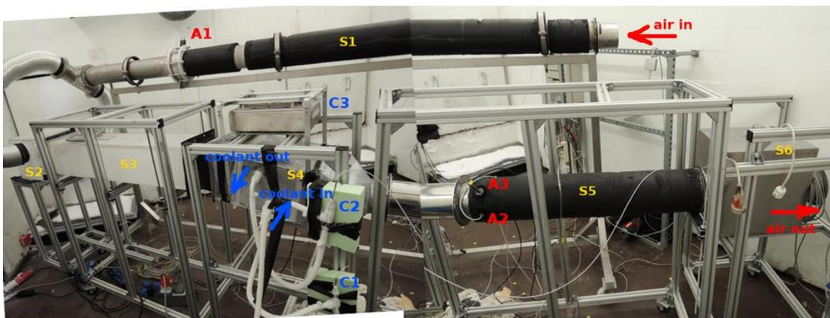
**Abbildung 3:** Überblicksdarstellung mit Einströmrohr, und Ausgleichskammer
