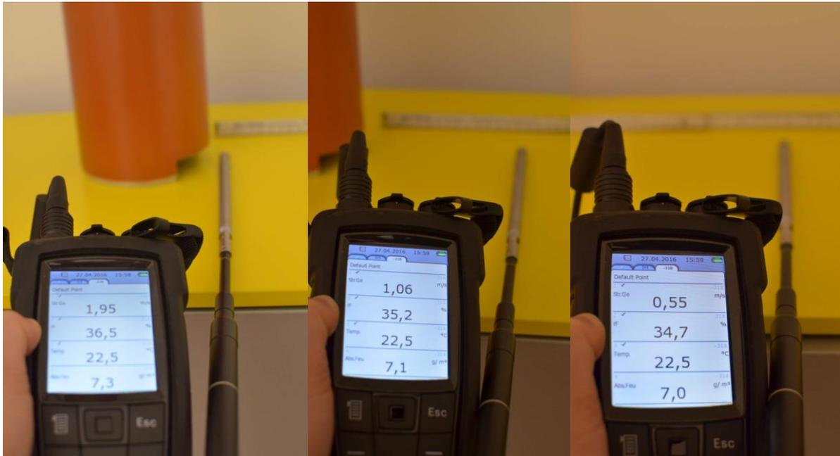
Abbildung 2-26: Messungen in Abhängigkeit der Distanz zur Ausblasöffnung
