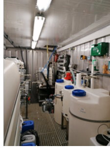
Abbildung 2: Eine in einem Container installierte Membrandestillationsanlage wurde für einen zweimonatigen Realbetrieb an der Abwasserreinigungsanlage Gleisdorf installiert (V.l.n.r: Containeranlage von außen, Container von innen, Membrandestillationsmodul), (Quelle: AEE INTEC)
