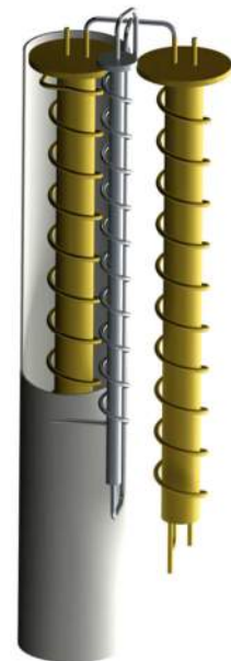
Abb. 2: Der Reaktor des „Flex Fuel Reformers“
