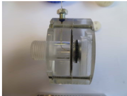
Abb. 5: Explosionszeichnung des Aufbaus für die Integration eines Peltier Elements (links) und ein Foto des Prototyps (rechts)
