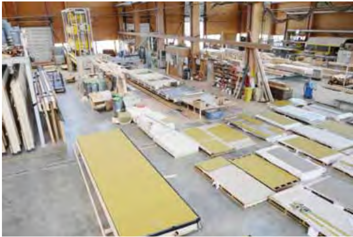
Peter-Schweizer-Schule Gundelfingen, Vorfertigung und Montage der Holztafelelemente. Planung: lattkearchitekten. Vorfertigung: Gump & Maier, Binswangen. Fotos: Frank Lattke (1), Stefan Thessenwitz (2)
