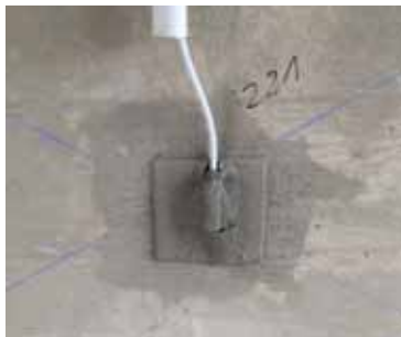
Messstelle mit Pt1000 Sensor
