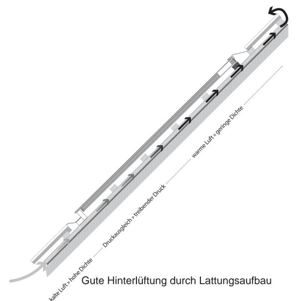
Gute Hinterlüftung durch Lattungsaufbau
