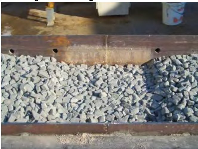
Abbildung 5: Verformungen der Granulatschicht nach (boden-)mechanischen Versuch
