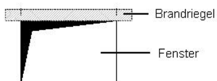
Abb. 28. Ansicht Fenster mit Brandriegel
