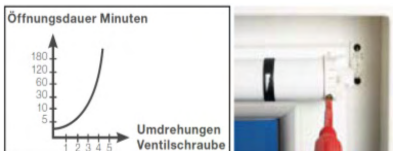
Abbildung 13: Einstellung der Öffnungsdauer; Quelle: Win Products GmbH (2010)
