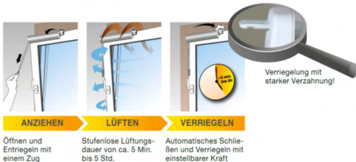
Abbildung 12: Funktionsweise automatischer Fensterschließer WINFLIP; Quelle: Win Products GmbH (2010)
