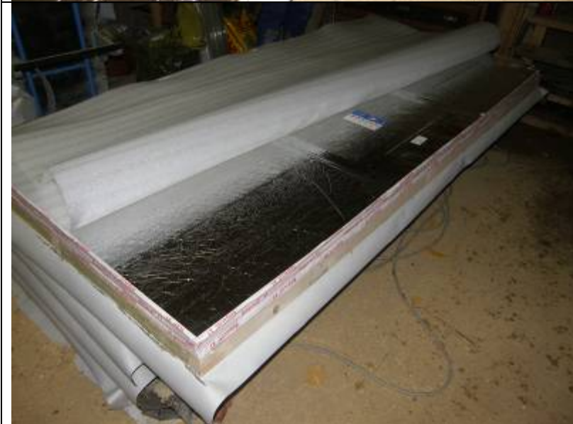
Bild 4 Aufbringen der Schutzfolie
