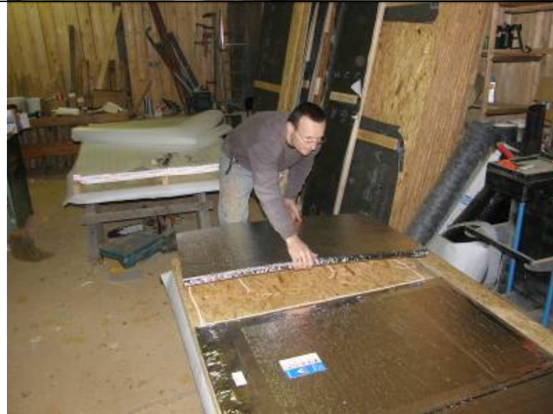
Bild 2 Umdrehen und Bekleben der Elemente mit Vakuumdäm- mung
