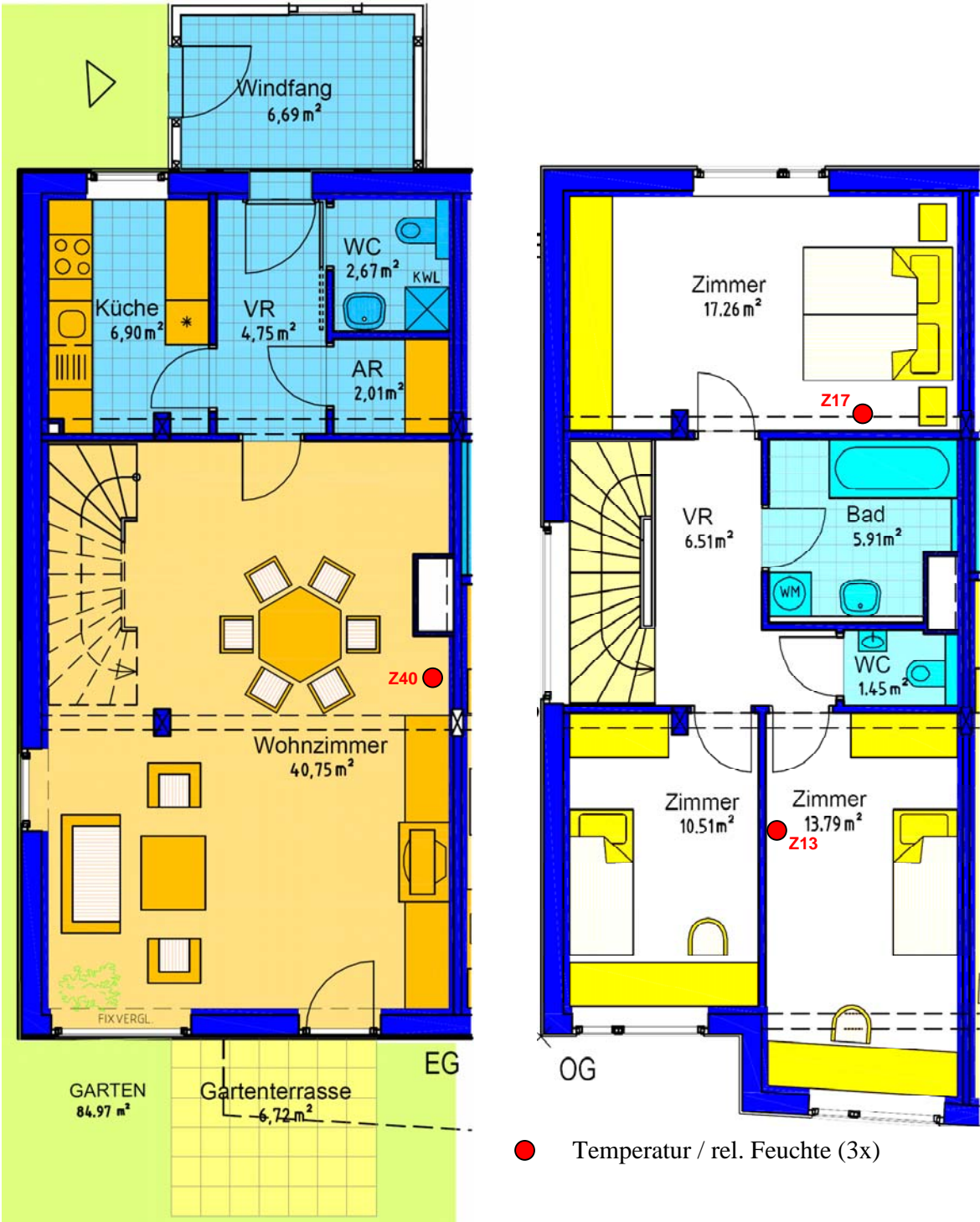
Abbildung 8: Positionierung der Temperatur-Feuchte-Sensoren in TOP1, Stiege 4
