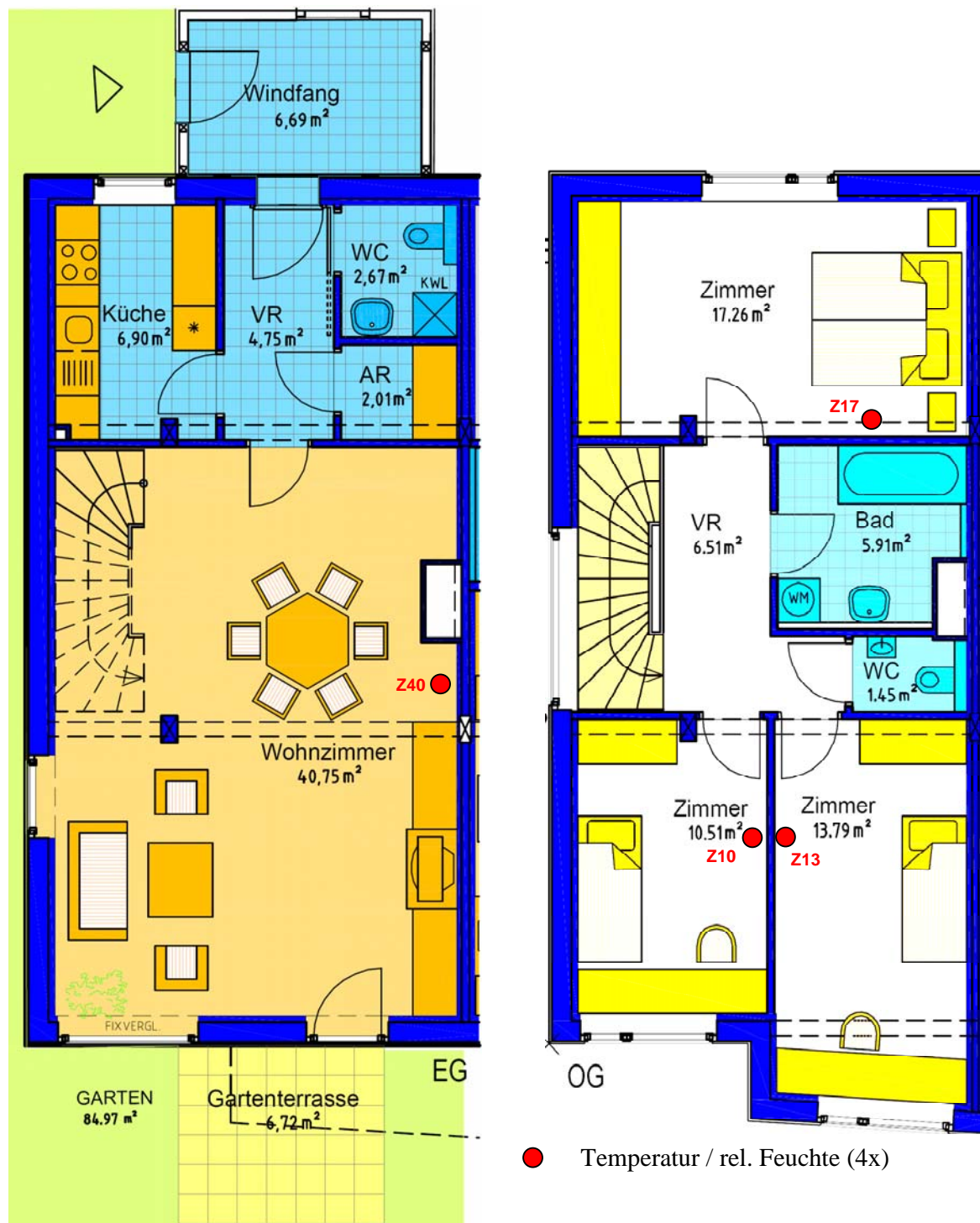
Abbildung 5: Positionierung der Temperatur-Feuchte-Sensoren in TOP1, Stiege 1,2,3
