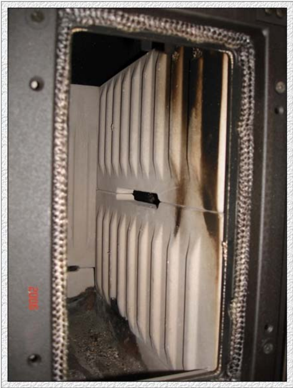
Bild 9: Prototyp 2, Feuerraum nach Abbrand
