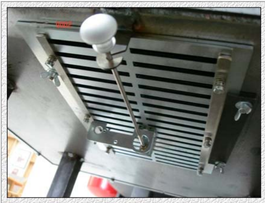
Bild 12: Prototyp 2, Luftschieber an der Unterselbe des Kaminofens
