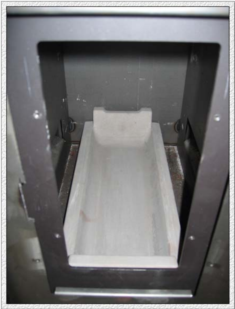
Bild 39: Prototyp 3. Feuerraumboden eingebaut
