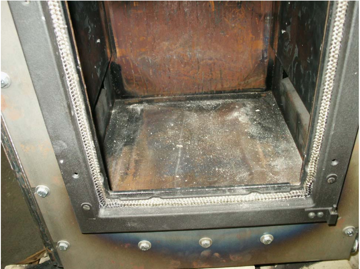
Abbildung 4: Brennkammer ohne Schamotte
