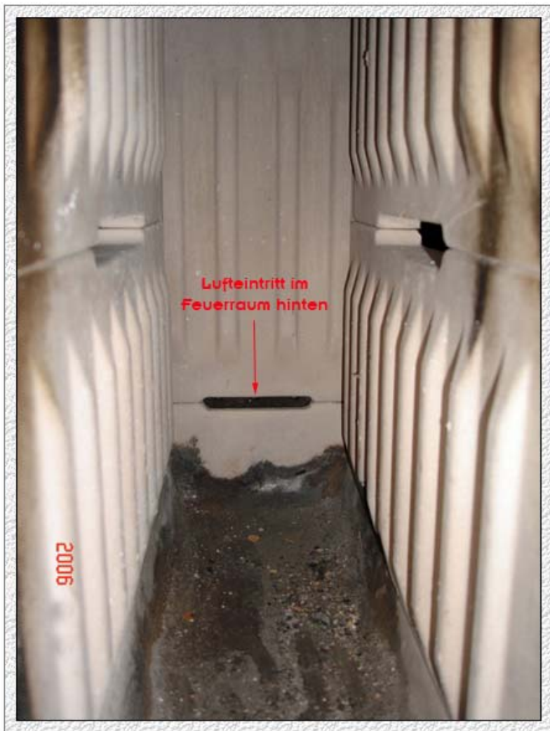
Bild 7: Prototyp 2. Feuerraum nach Abbrand
