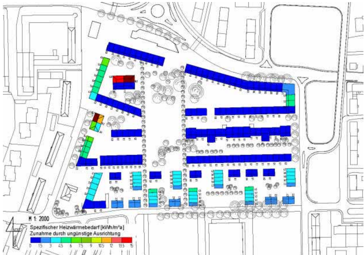
Abbildung 69: Zunahme des spezifischen Heizwärmebedarfs durch ungünstige Ausrichtung
