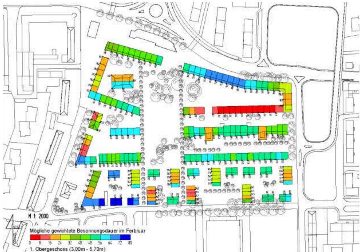
Abbildung 73: Besonnungsdauer über den gesamten Februar im 1. Obergeschoss
