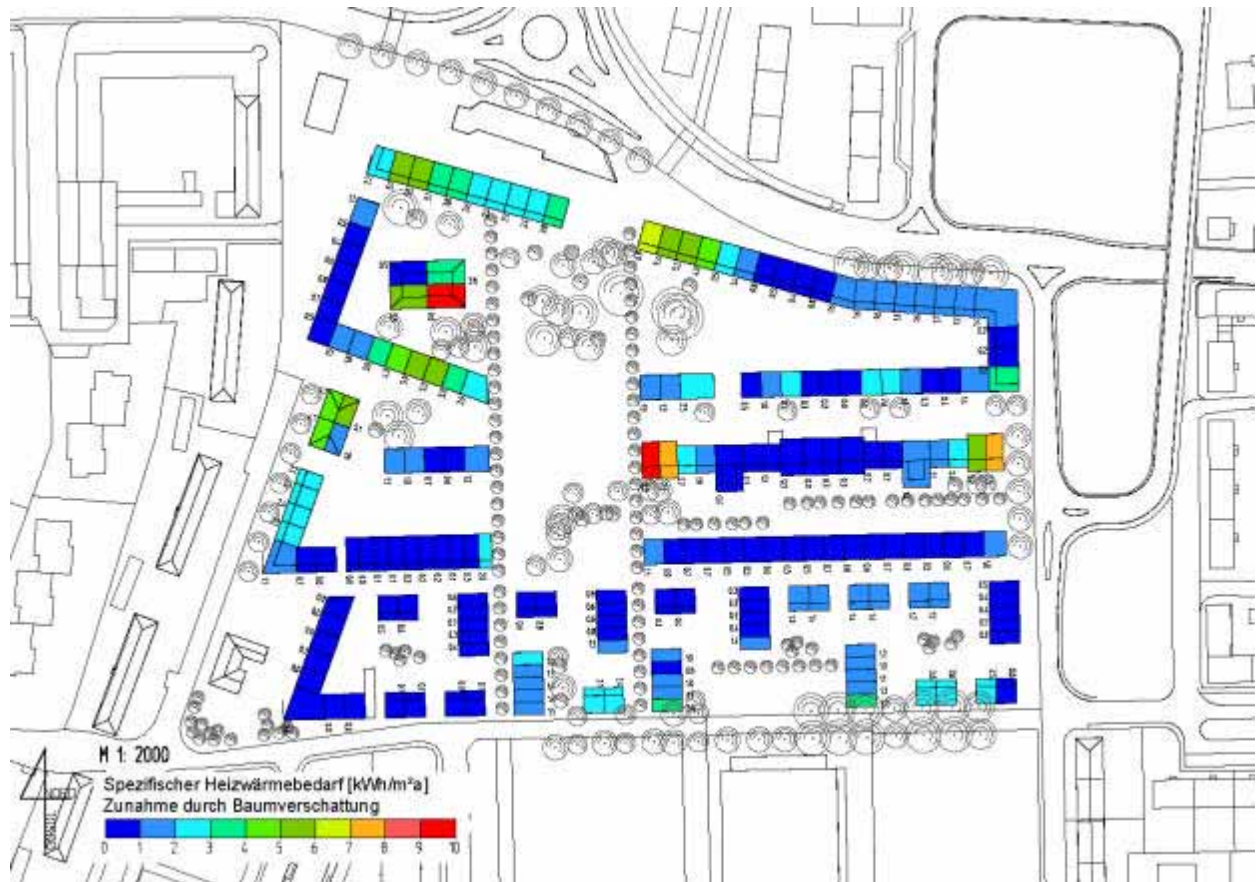
Abbildung 67: Zunahme des spezifischen Heizwärmebedarfs durch Baumverschattung
