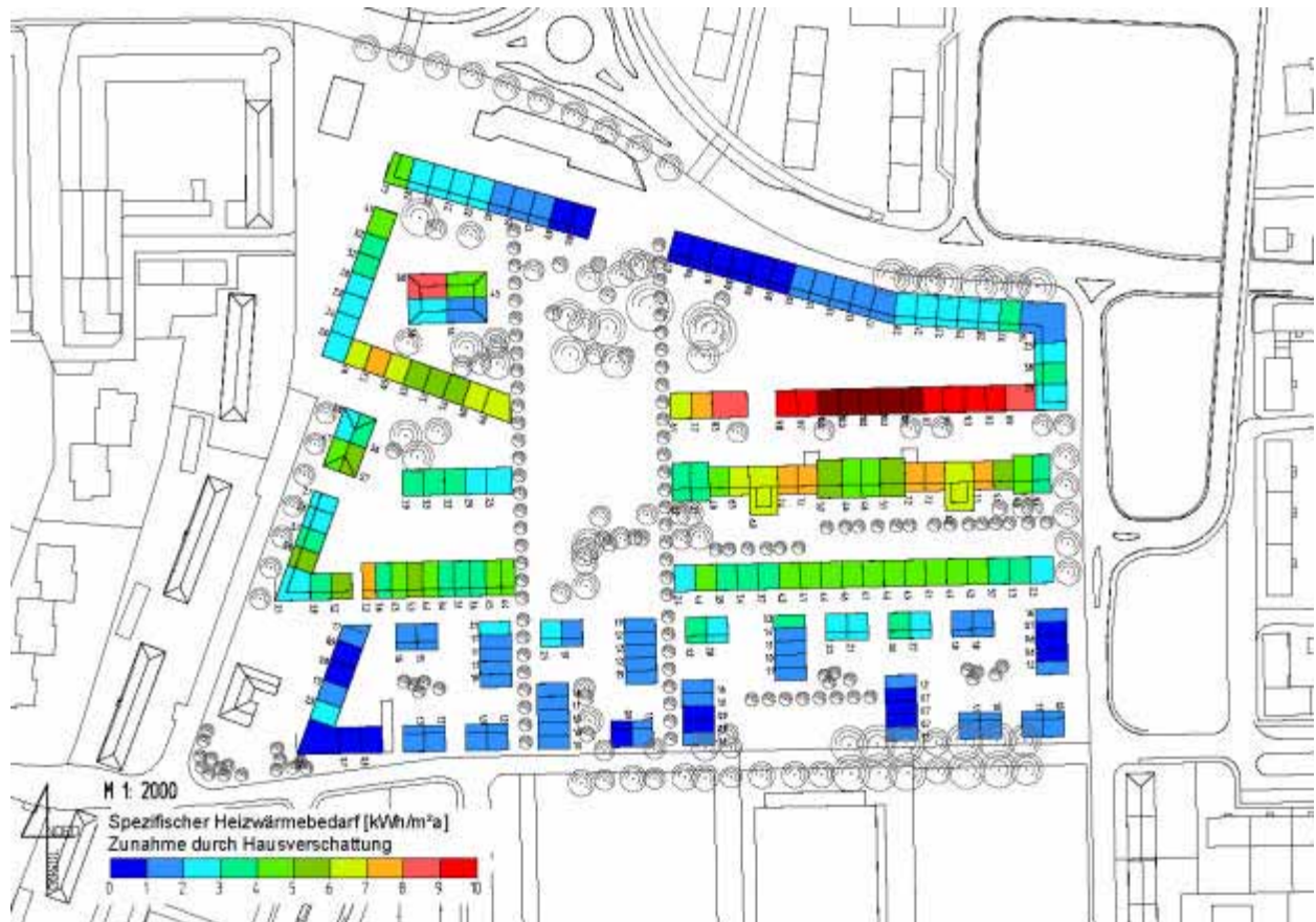
Abbildung 68: Zunahme des spezifischen Heizwärmebedarfs durch Hausverschattung
