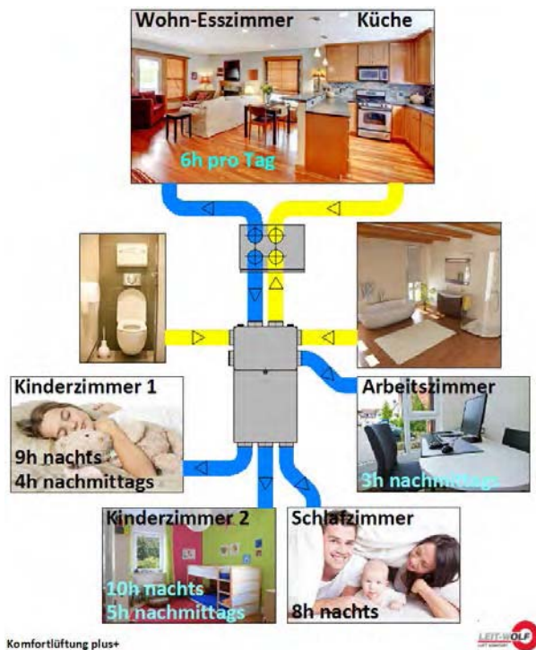
Abbildung 2: variable Belüftung entsprechend der Nutzungszeiten
