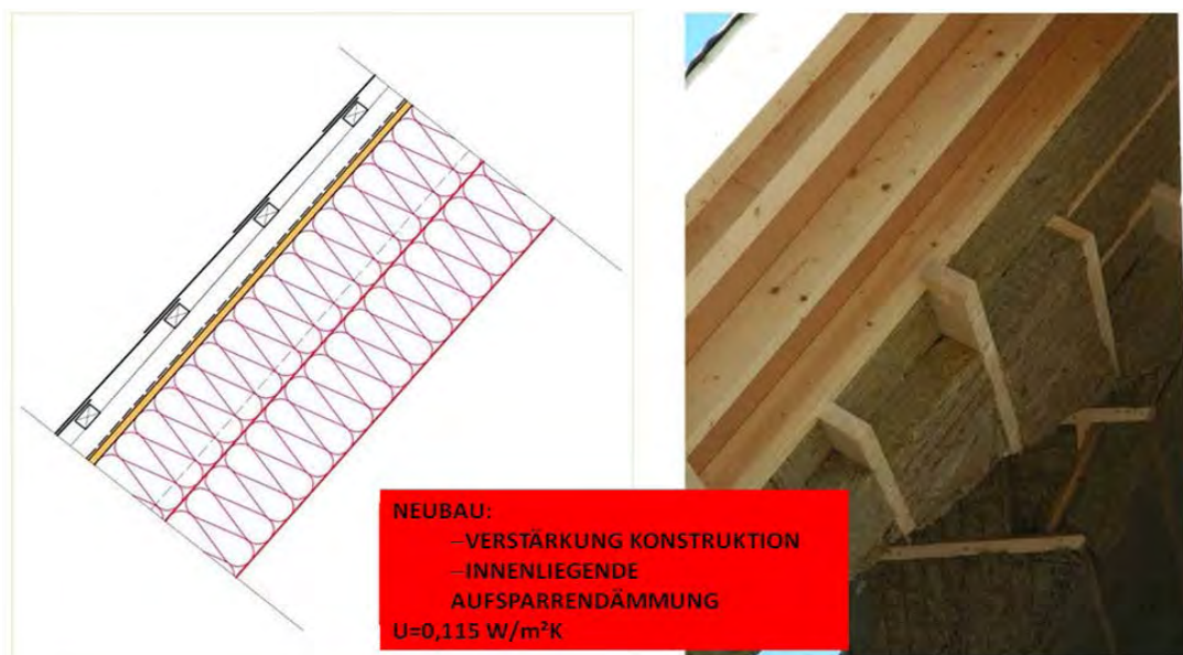
Abbildung 2-11: Detail des Dachaufbaus - Bauablauf (Quelle: Architekten Kronreif_Trimmel&Partner)
