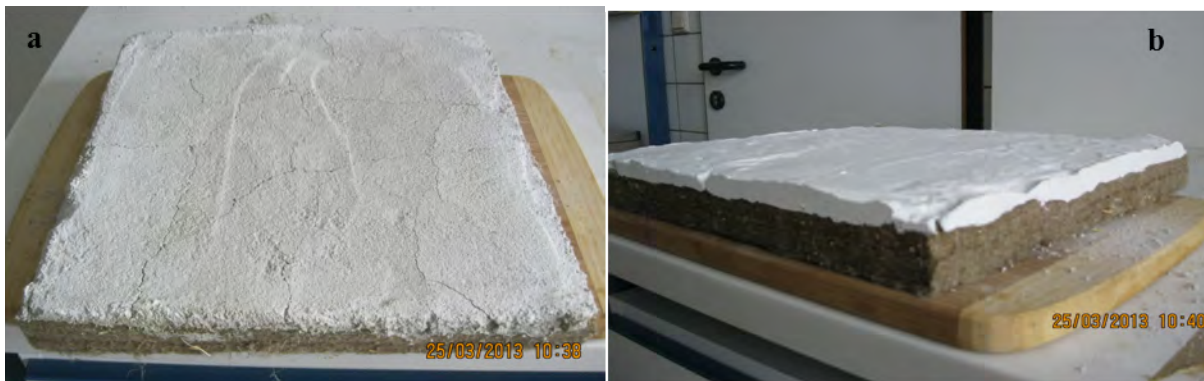
Abbildung 10: a) Vernadelte, mit Außenputz beschichtete Flachsfaser-Dämmplatte. b) Vernadelte, mit Grünband-Putz beschichtete Flachsfaser-Dämmplatte
