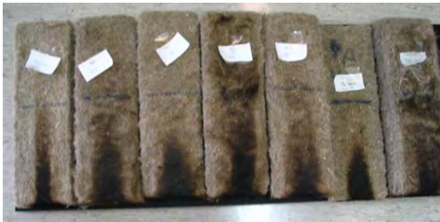
Abbildung 8:Original (li), 8A, 8C, 9A, 9A, 9A vernadelt, 9B (re) nach den vororientierenden Brandtests.
