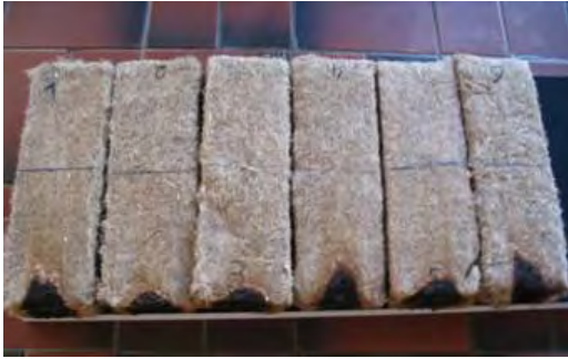
Abbildung 9: Geglättete Proben mit 4,35% FM nach dem Norm- Brandtest
