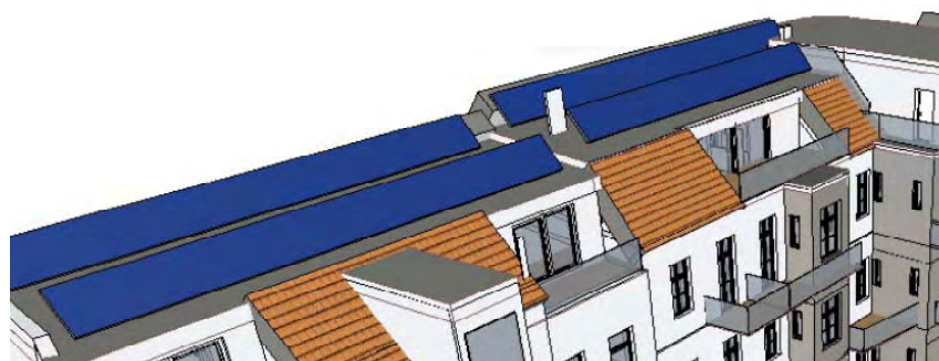
Abbildung 39: Solarthermische Anlage am Objekt David's Corner
