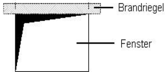
Abb. 28. Ansicht Fenster mit Brandriegel
