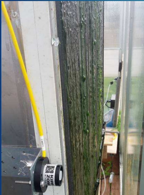
Biofilm-Aufwuchs, von hinten mit Abwasser versorgt.
