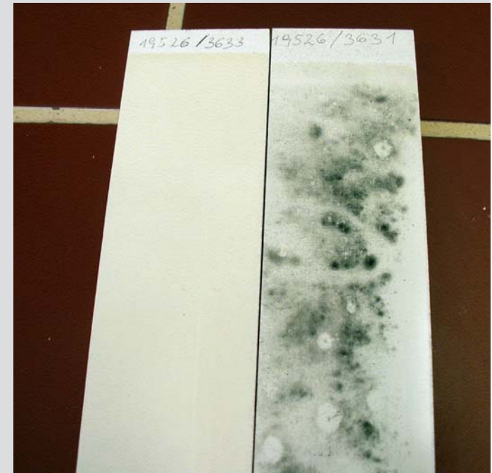
Abb: Die Wirkung der antistatischen Additive wurde auch mittels Staubtest eindrucksvoll geprüft
